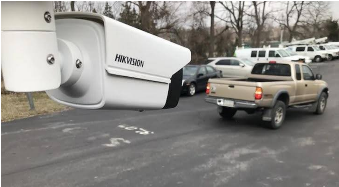
Figura 12.17. Incorporación de cámaras de alta resolución (Hikvision) para detección de patentes.
